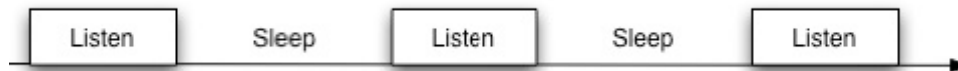
Figura 4.1: División del tiempo en periodos de escucha y sleep. Los nodos sólo pueden recibir mensajes en la fase de escucha. Durmiendo el resto del tiempo, los sensores ahorrarán energía.
